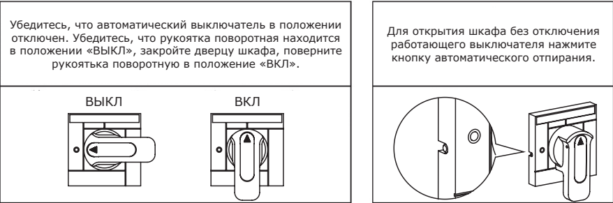
Рисунок 5 – Основные положения рукоятки поворотной
