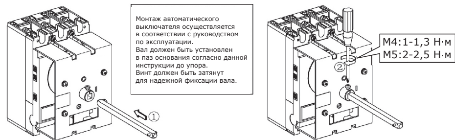
Рисунок 3 – Установка стержня поворотной рукоятки
